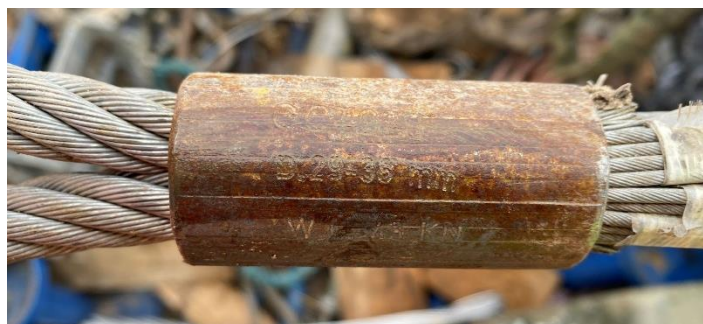
Rys. 16. Widok zakresu średnic przewodu obsługiwanych przez uchwyt montażowy
