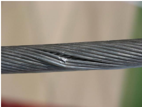
Rys. 2a. Widok uszkodzonych drutów warstwy zewnętrznej – zaciągnięcie
