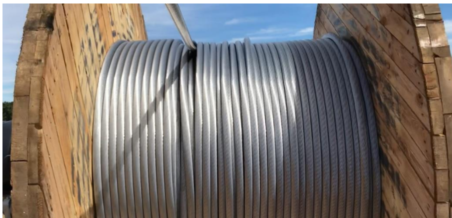
Rys. 13. Widok zapadania się przewodu na skutek zbyt dużej siły naciągu
