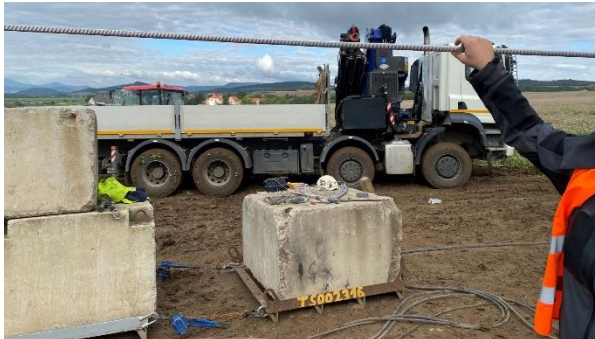
Rys. 14a. Widok sposobu kontroli optymalnej wartości naciągu – bez obciążenia
