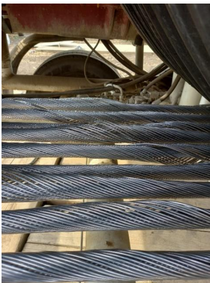
Rys. 1a. Widok zluzowanej warstwy przewodu
