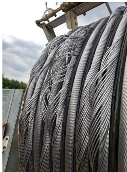
Rys. 1b. Widok zluzowanej warstwy przewodu
