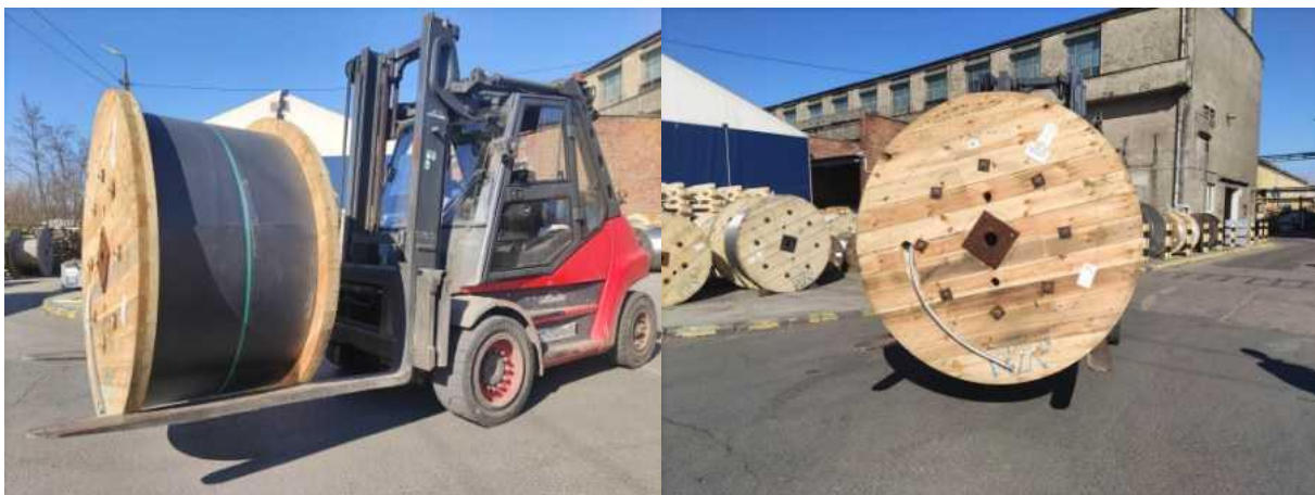
Rys. 4. Widok sposobu podnoszenia bębna za pomocą wózka widłowego
